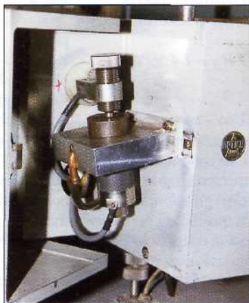
Fig. 5 - Quantometro (prove chimiche).
