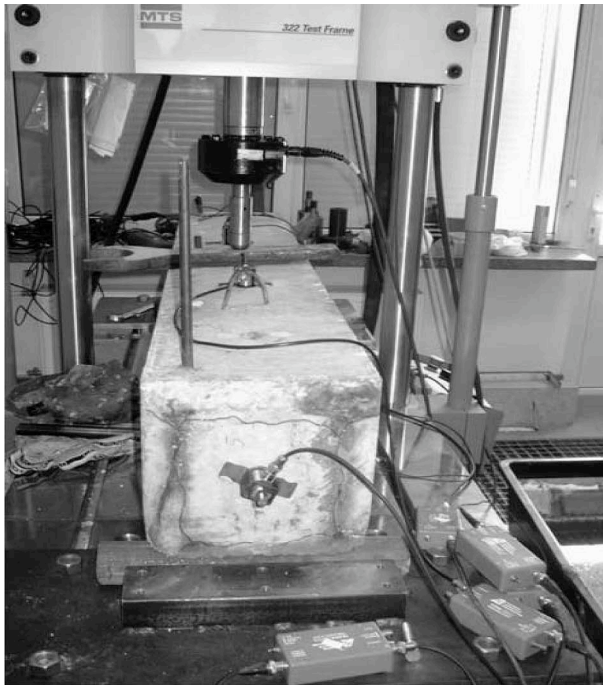
Figura 3. Travetto di calcestruzzo armato durante il ciclo di carico
