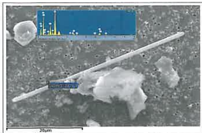
Figura 2 - Un'immagine al microscopio a scansione elettronica di una fibra di fluoroedenite con relativo spettro EDS
