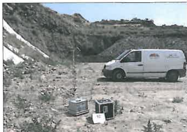
Figura 3 - Il campionatore ambientale ZB1 Battery utilizzato per il prelievo dei campioni
