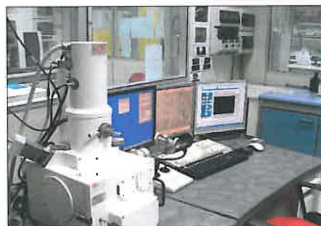
Figura 4 - Il microscopio a scansione elettronica SEM LEO 1430 utilizzato per la determinazione della concentrazione di fibre aerodisperse
