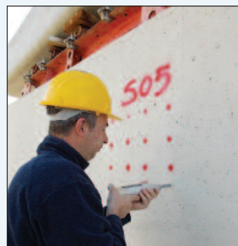
7. Lo sclerometro di Schmidt è la prova non distruttiva che correla la durezza superficiale con la resistenza alla compressione del calcestruzzo ( R_c )
