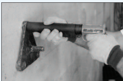
9A e 9B. Il metodo penetrometrico richiede l'infissione, mediante l'impiego di una carica balistica calibrata, di una sonda di geometria nota
