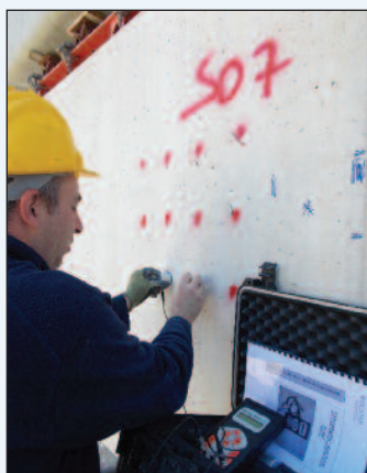
6. La trasmissione di onde elastiche generate da una sonda trasmittente ad alta frequenza che emette impulsi ad ultrasuoni
