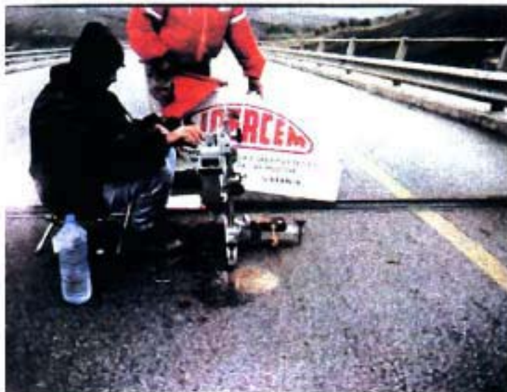
Foto 2: Skid Test - Fase di prova (C.N.R. B.U. n°105)
